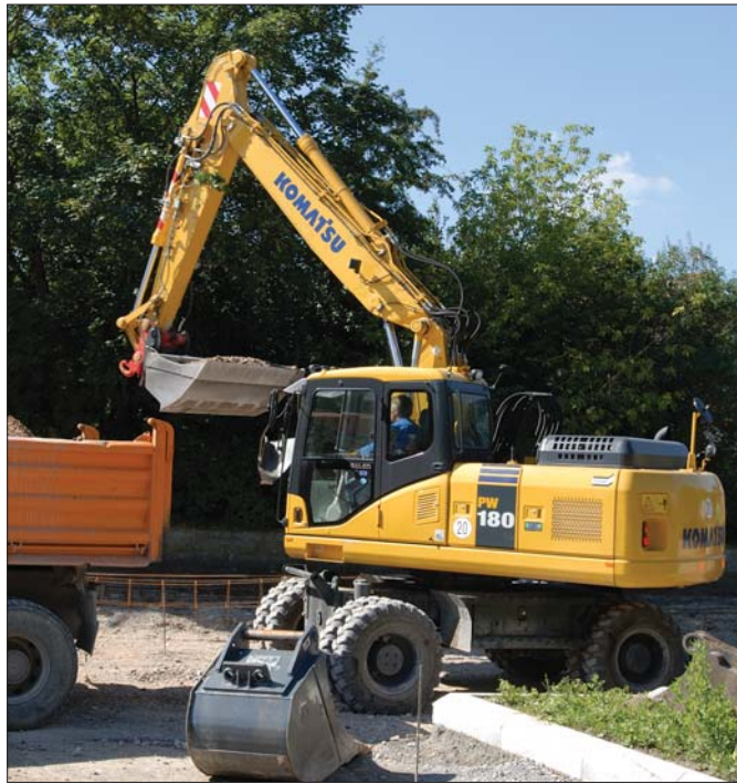
Operator koparki PW180-7 może korzystać z czterech trybów roboczych optymalizujących prędkość obrotową silnika, wydatek pompy i ciśnienie w układzie hydraulicznym
