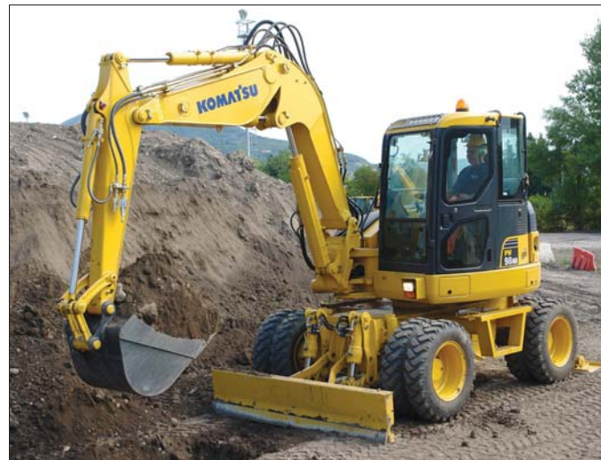
Budowa nadwozia koparki sprawia, że doskonale spisuje się ona podczas prac na ograniczonej przestrzeni mogąc pracować bardzo blisko ścian i innych przeszkód
