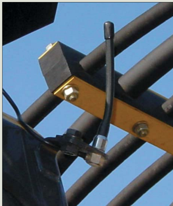
Na zewnątrz widać tylko niepozorną antenę. Serce systemu Komtrax optymalizującego pracę maszyn Komatsu mieści się w niewielkiej skrzyneczce zintegrowanej z komputerem pokładowym...
