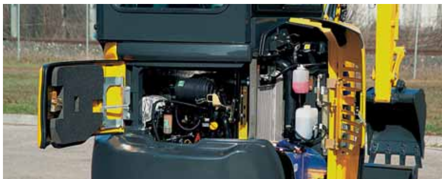
Tylne pokrywy do szybkiej kontroli silnika, łatwej obsługi, czyszczenia chłodnicy i łatwego dostępu do akumulatorów.
